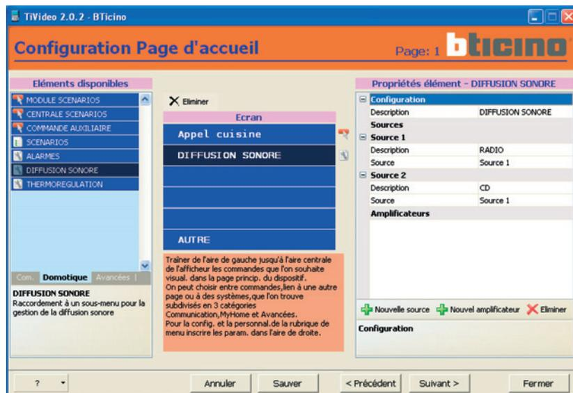
En cliquant sur la touche **+ Nouvel amplificateur** ajouter les amplificateurs du système de Diffusion sonore (max. 6) que l'on entend contrôler par l'intermédiaire du dispositif. Configurer pour chaque amplificateur l'adresse A-PF et personnaliser la description.
